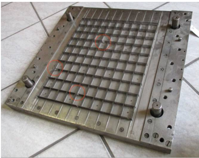
il. 7 płyta mocująca narzędzia perforującego maszyny Wifag. Również i w tym przypadku w składzie narzędzia jest zespół stabilizacyjny i matryca. Zaznaczone wyłamania i zagięcia igieł powstały już po demontażu.
