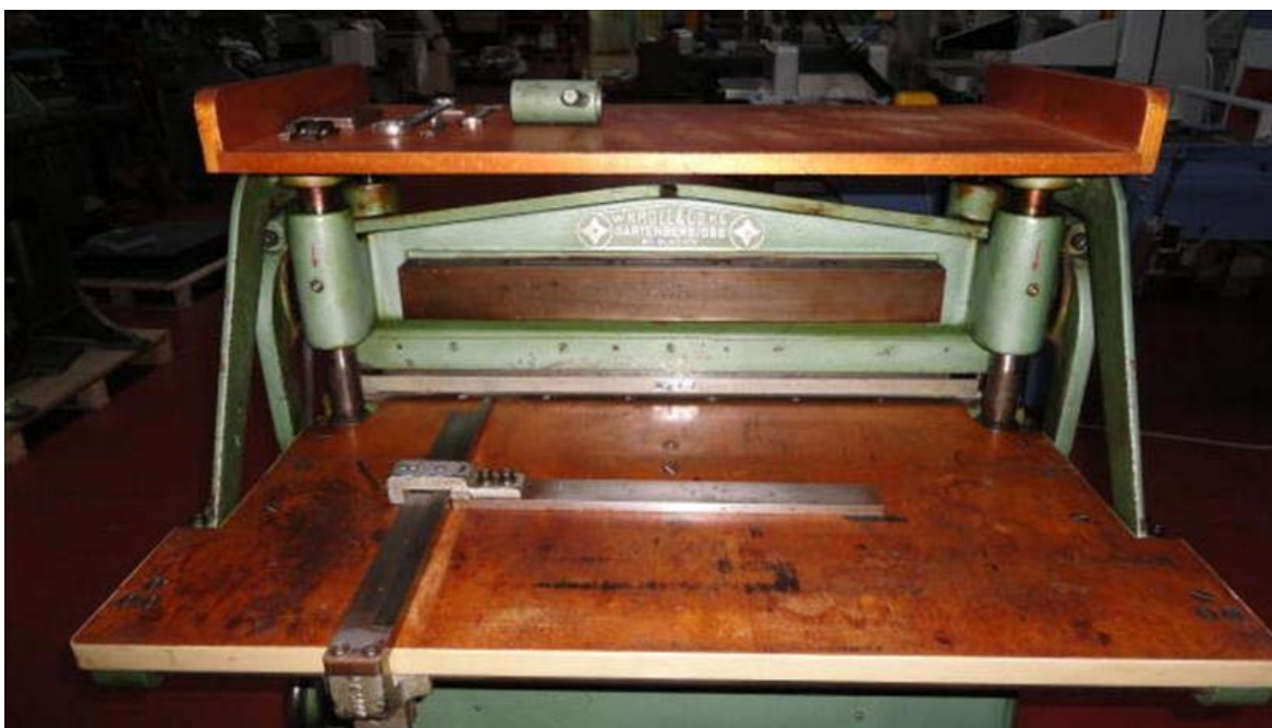
il. 4 perforówka Kroll & Co z napędem elektrycznym o max. szerokości perforacji 68 cm i 48 cm głębokości stołu.
